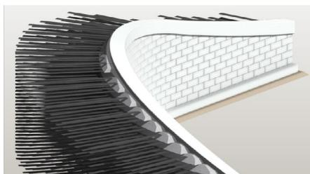
Модель армогрунтовой стены.
