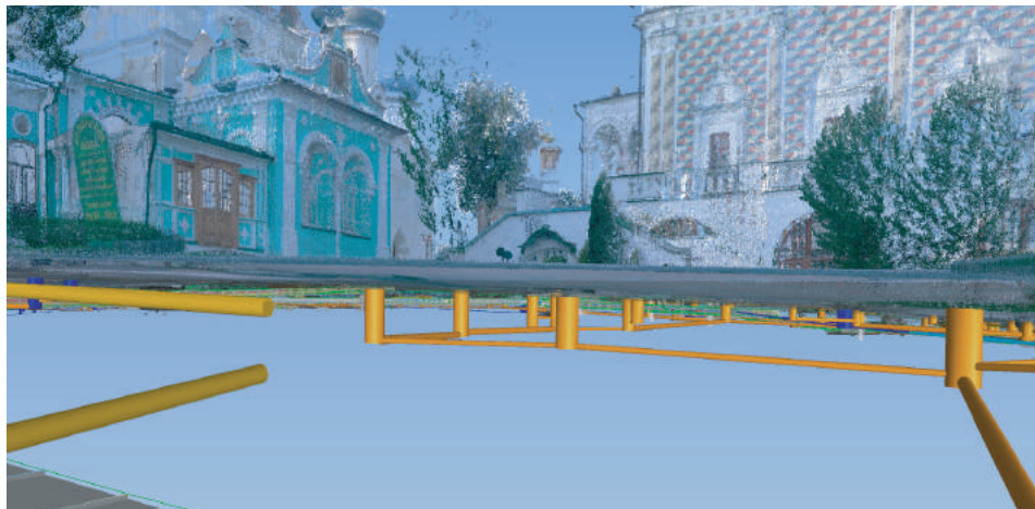
Совмещение облака точек, полученного в результате сканирования, с моделью инженерных коммуникаций. Изображение предоставлено «РОСЭКО-СТРОЙПРОЕКТ»
