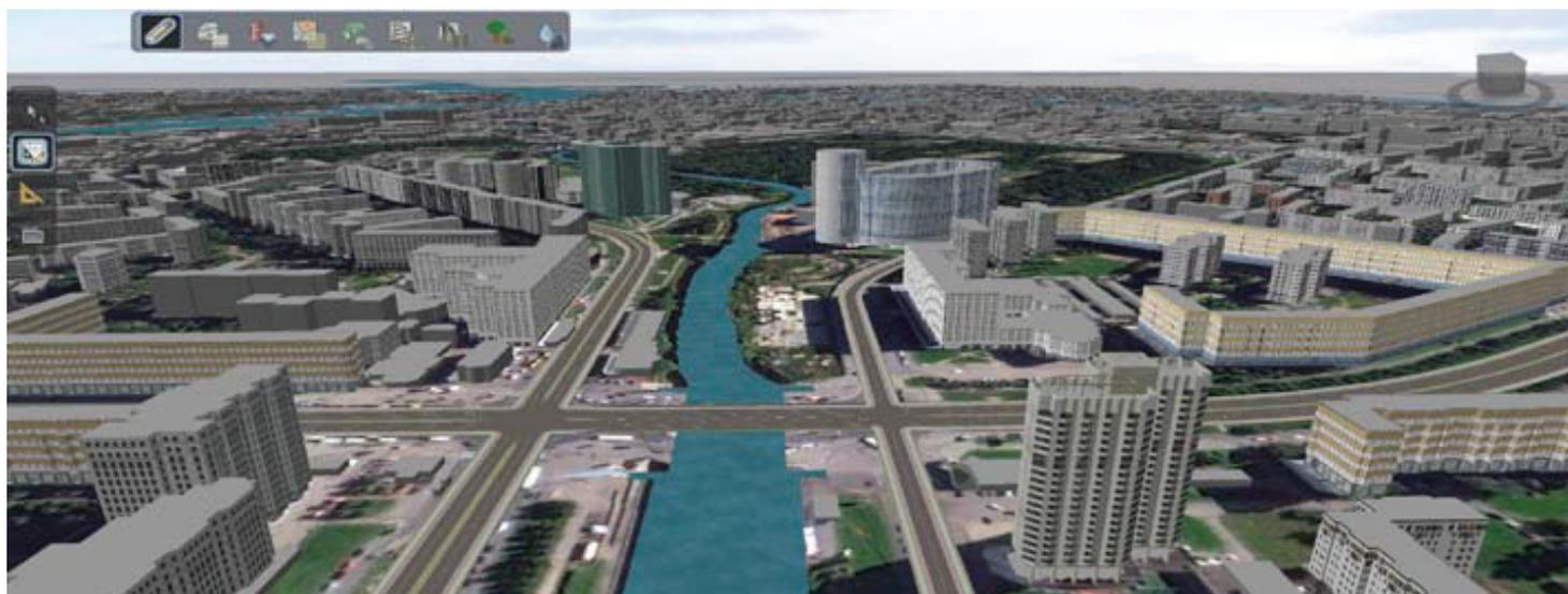
Вид модели после прокладки дорог, наложения данных спутниковой съемки и полуавтоматического распределения фасадов
